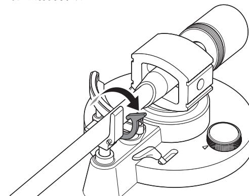
4 将拾音臂移动离开拾音器臂架，轻轻推向左侧。
