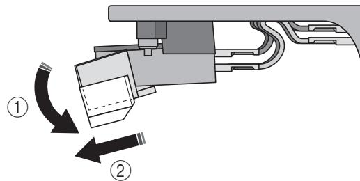
**3** 用手指固定唱頭本體時，請將更換唱針的凸耳插入唱頭底部溝槽中。
